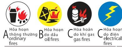
A Hòa hoạn thông thường ordinary fires      B Hòa hoạn do dầu oil fires      C Hòa hoạn do khí gas gas fires      C Hòa hoạn do điện electrical fires
