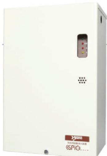
Thông qua cơ chế cảm biến siêu nhạy, thiết bị nhanh chóng nhận biết được sự gia tăng của nhiệt độ khi phát sinh hỏa hoạn, nhờ đó thiết bị cảm ứng tính năng cao sẽ được kích hoạt và tự động phun chất chữa cháy. Chất chữa cháy an toàn có sử dụng chất dập lửa dạng dịch (trung tính) lành mạnh và thân thiện với môi trường mà không sử dụng PFOA.
